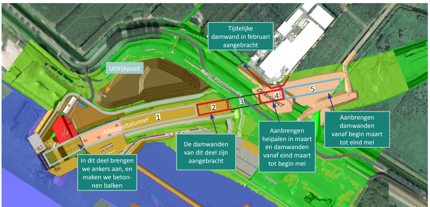
Afbeelding 1 Locaties aanbrengen damwanden Maasdeltatunnel noord
