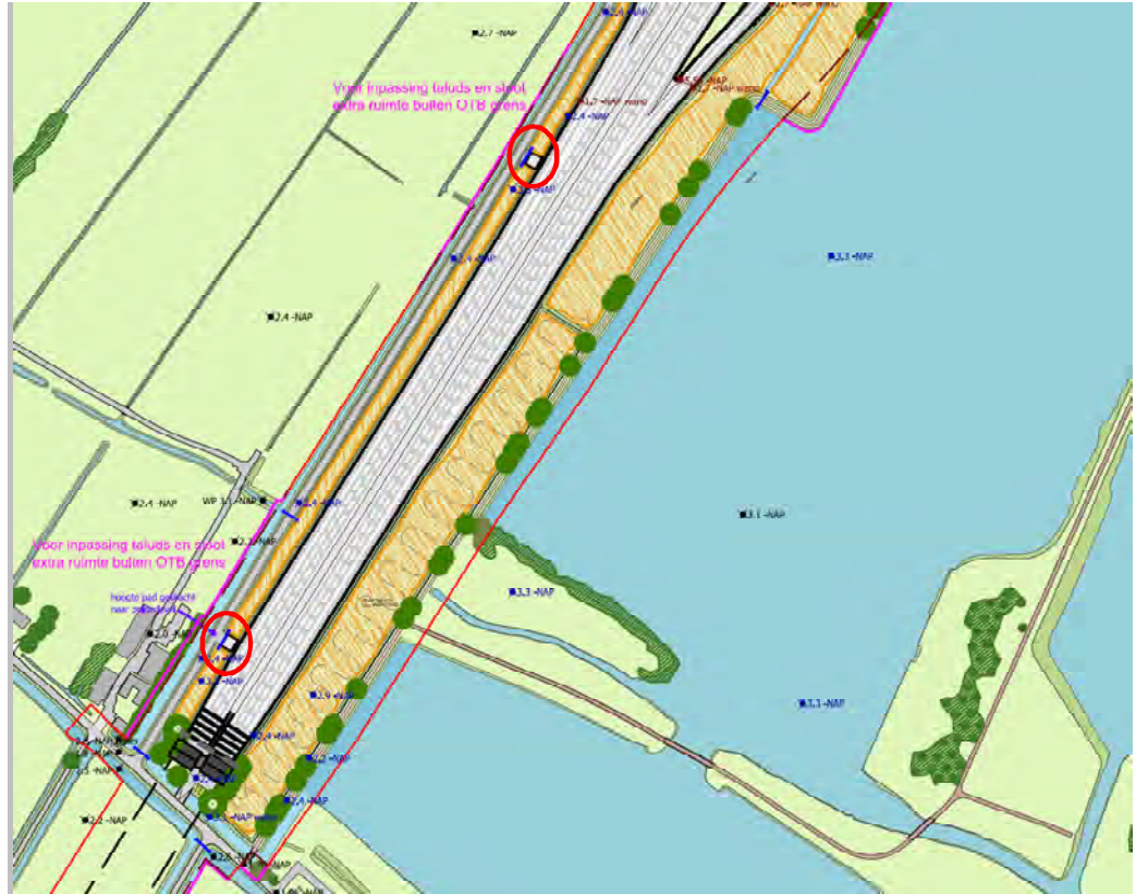
Afbeelding 2.7. Positie trappen ten noorden van tunnel
